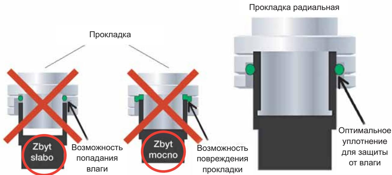
В традиционных соединениях, его качество зависит от монтажника. В одних случаях недостаточно плотно скрученные части соединения, в других слишком большое усилие. Такие соединения могут не обеспечивать требуемой степени защиты.
