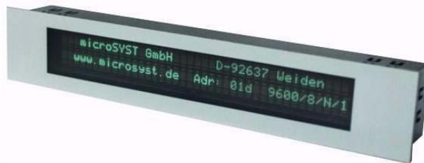
**mitex DP VFC 2x40**– это щитовые индикаторы (для монтажа в вырез панели) на основе вакуумных флуоресцентных индикаторов. Для передачи выводимой на экран информации используются интерфейс промышленной сети **Profibus DP**.
