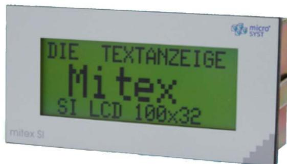
**Mitex SI LCD 100x32**— это щитовые индикаторы (для монтажа в вырез панели) на основе матричных жидкокристаллических индикаторов. Для передачи выводимой на экран информации используются последовательный интерфейс RS232.
