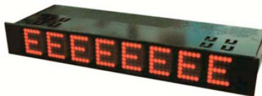
**mitex LED** – это щитовые индикаторы (для монтажа в вырез панели) на основе матричных светодиодных индикаторов. Для передачи выводимой на экран информации используются интерфейс промышленной сети **Profibus DP**.
