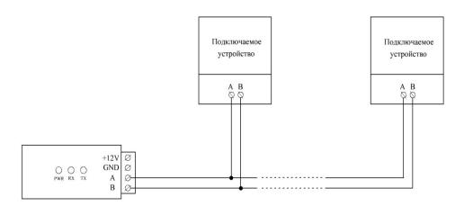
Длинная линия. Схема подключения:
