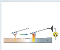
□ Кельвин-зондовая силовая микроскопия
