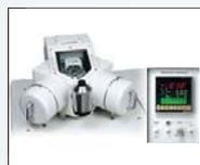
□ Модуль нагрева и охлаждения образца
