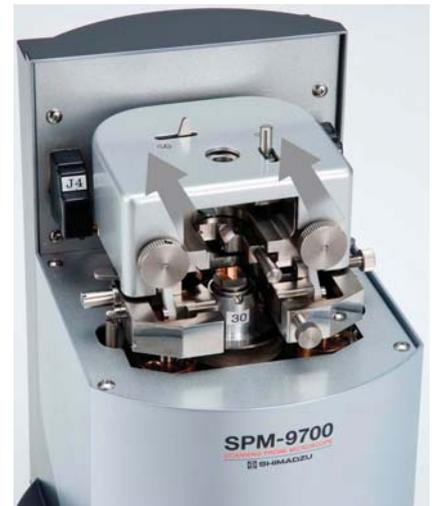
Смена образца без отключения лазера и удаления кантилвера
