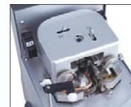
□ Камера CH-II (без турбомолекулярного насоса)
